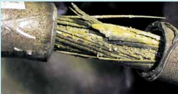
Рис. 15. Фрагмент провода со следами износа
