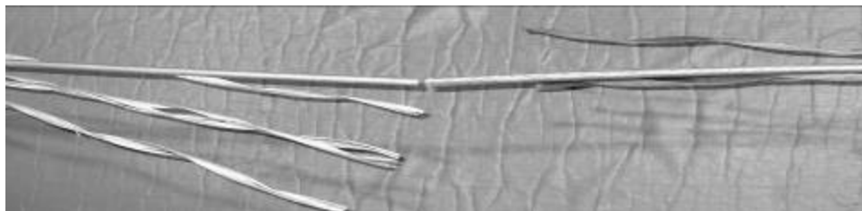
Рис. 3. Расплетенные проволоки верхнего повива.
