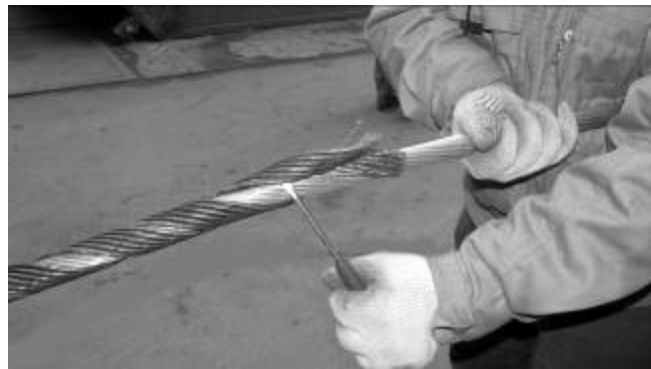
Рис.7. Монтаж последнего вика зажима отверткой.
