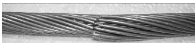
Рис. 2. Поврежденные проволоки провода уложенные в повив провода.
