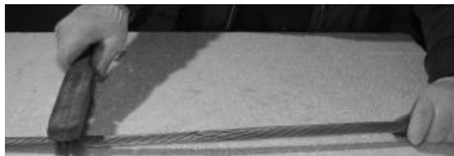
Рис. 3. Удаление окислов алюминия металлической щеткой.
