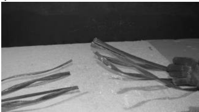
Рис.2. Расплетен верхний повив провода.
